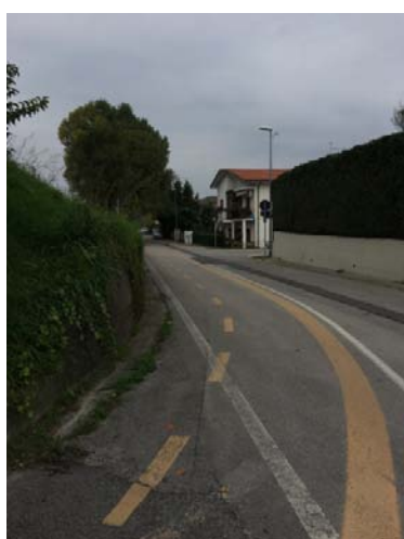
Esempi di corsia ciclabile su strada. Nel primo ha la funzione di delimitare una sede riservata al transito delle biciclette nello stesso senso dei veicoli, nel secondo e nel terzo di consentire il traffico bidirezionale delle biciclette su una strada a senso unico.
