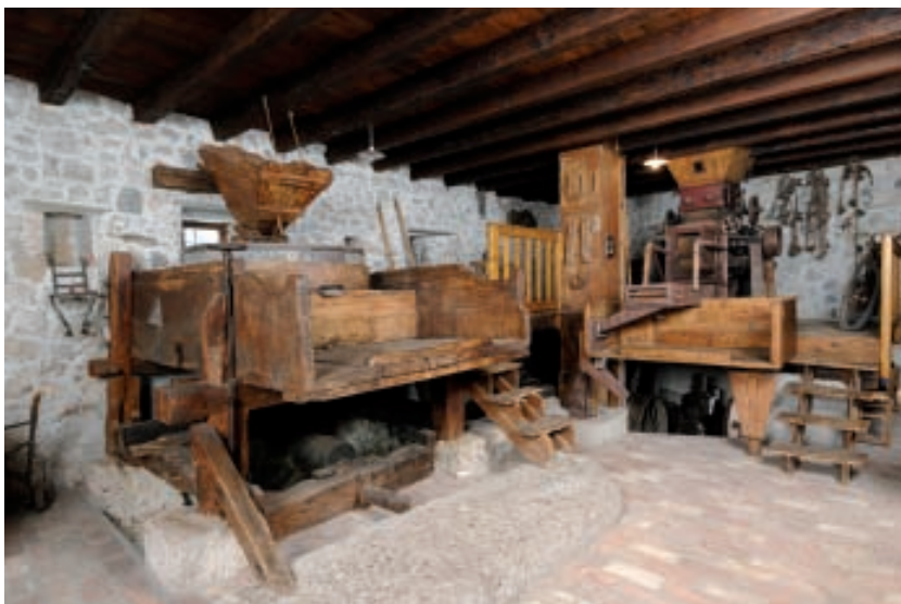
Il museo dell'arte molitoria all'interno del mulino Cocconi. Vi sono esposte due macchine: una a palmenti (macine) risalente all'inizio dell'Ottocento quando la famiglia Cocconi divenne proprietaria dell'opificio subentrando ai de Brugnig, l'altra a cilindri più recente.
