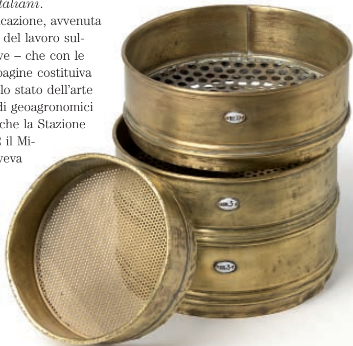
Serie di setacci utilizzati nell'analisi granulometrica del terreno appartenuta alla Stazione Chimico - Agraria Sperimentale di Udine.
