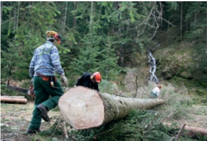
In condizioni difficili si procede con metodi tradizionali: qui vediamo la sramatura praticata con motosega e la depezzatura previa misurazione con cordella metrica.
