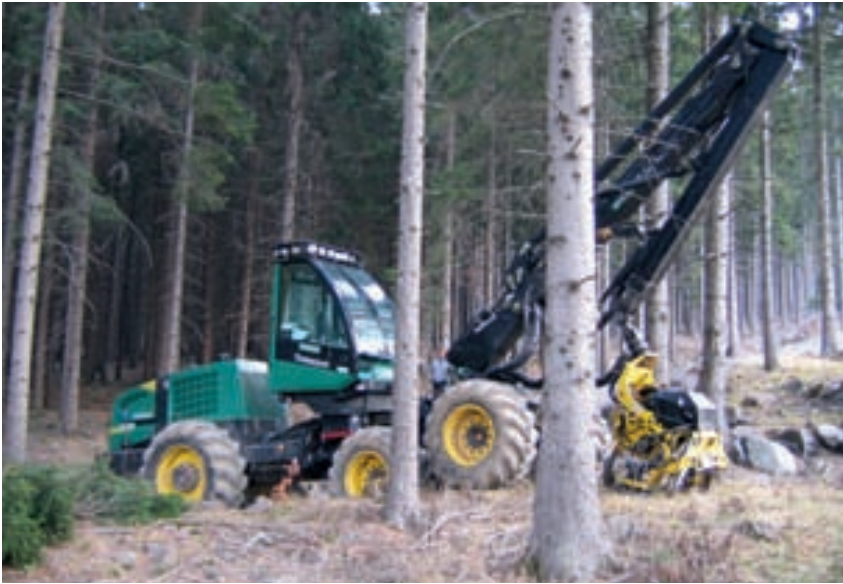
Moderno Harvester in opera nella Foresta regionale di Pramasio. Questa macchina consente operazioni molto veloci, assicurando un'alta produttività accanto alla sicurezza per gli operatori; abbisogna, naturalmente, di una buona rete di viabilità forestale.
