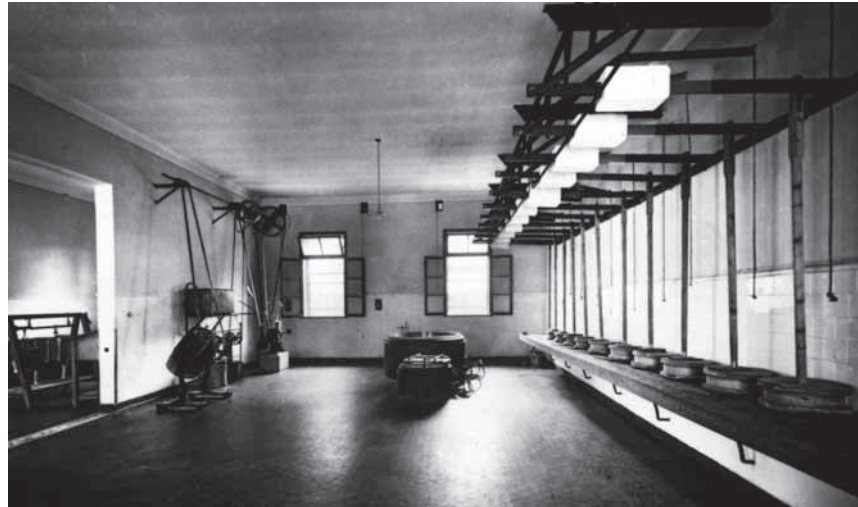
Sala lavorazione della latteria di Spilimbergo all'inizio dell'attività. Le macchine venivano azionate in un primo tempo dall'acqua della roggia che scorreva nei pressi dell'edificio, successivamente da un motore posto in fondo alla sala, tramite un albero di trasmissione che faceva scorrere le cinghie. Archivio Guido Corrado.
