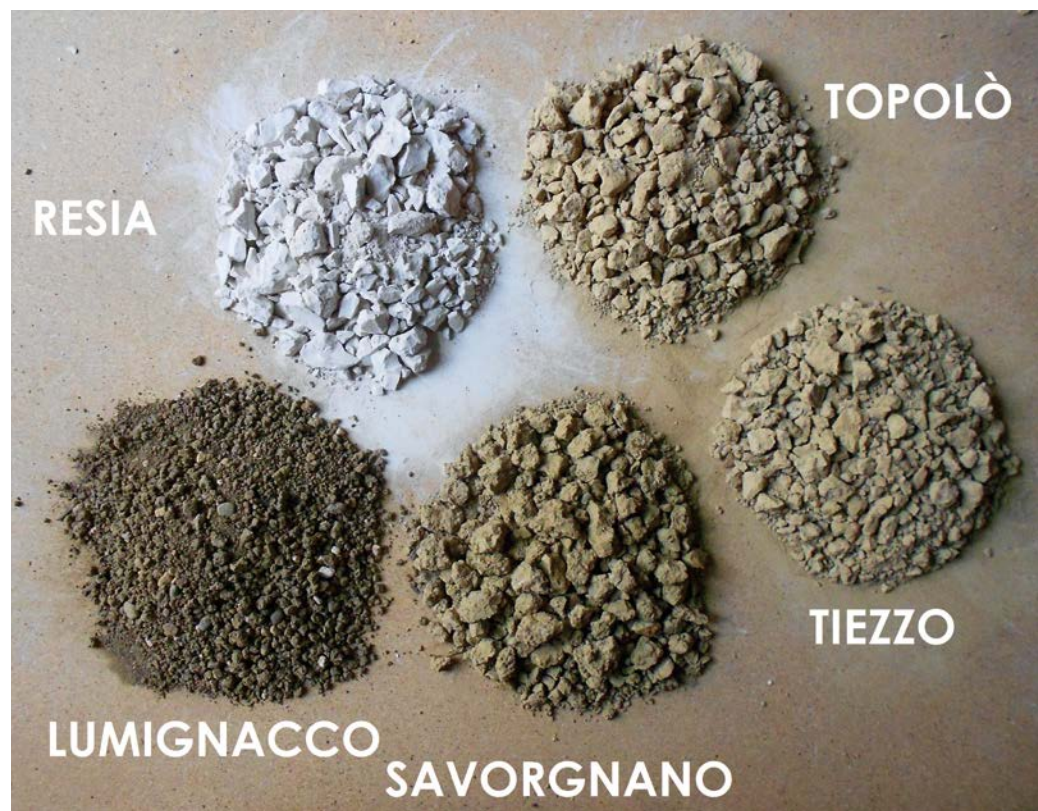
La terra con cui sono stati costruiti cinque edifici da noi reperiti in regione. Come si vede ogni ambiente esprime un suo materiale costruttivo. Foto G. Ganis.
