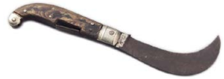
Roncola con caratteristico manico in corno, con ghiera e calcagno in alpacca, dettaglio che crea un effetto simile a quello dei manici delle zuave. Il manico è incurvato verso il dorso assumendo così la classica forma della roncola. La lama è a costa piatta, sezione cuneata, tagliente liscio, punta falcata e reca il marchio Maniago (Maniago, Collezione MAFC).
