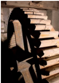
Ingranaggio con denti di legno. Per questo scopo era utilizzato legno di robinia o di carpino bianco per l'impiego rispettivamente all'aperto o all'interno.
