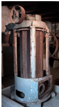
La macchina lavagrano della marca Golffetto. Il ciclo di lavorazione del frumento iniziava con la pulitura e la lavatura.
