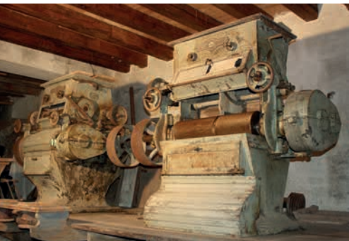
I vecchi laminatoi ungheresi dei primi del Novecento. In quattro passaggi fornivano farina da pane. Da metà degli anni Cinquanta fino alla chiusura vennero adibiti alla macinazione del mais.
