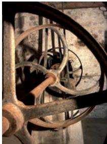
L'albero maestro correva attraverso il mulino per una quindicina di metri con pulegge ed ingranaggi.
