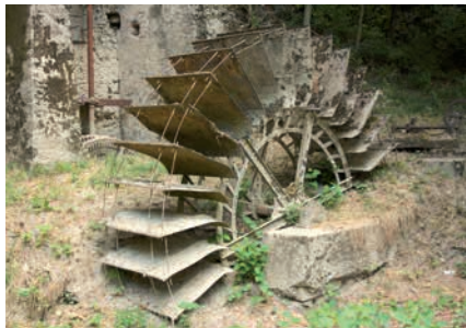
La grande ruota a pale di cinque metri di diametro. Osservandola, si nota l'assenza di saldature: è tenuta assieme da tiranti e dadi su un asse con supporti.
