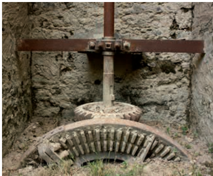
La prima coppia conica che si incontra dopo la ruota, anch'essa per metà interrata, rinviava il moto su un asse verticale alto una decina di metri.
