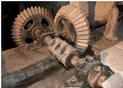
All'interno del mulino una coppia conica muove l'albero maestro che distribuisce il moto a tutte le macchine del complesso attraverso pulegge e cinghie di cuoio.
