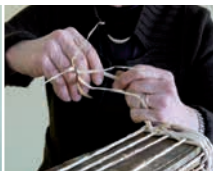
Le mani della cartocciaia arrotolano le brattee per allungare via via la corda della trama che viene intrecciata all'ordito durante la fabbricazione di una sporta.
