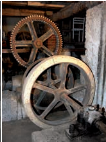
L'albero maestro correva attraverso il mulino per una quindicina di metri con pulegge ed ingranaggi.
