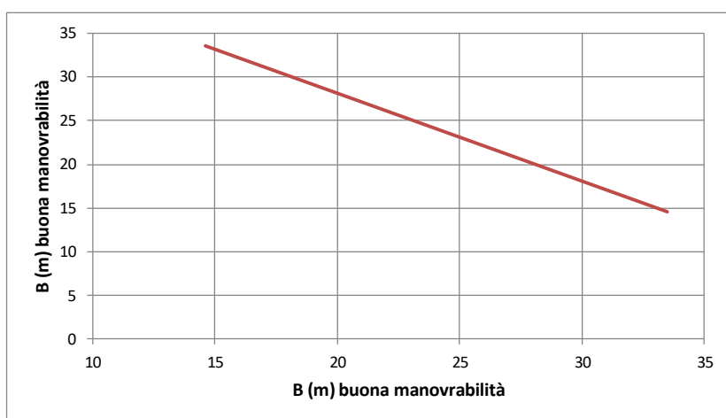
Figura 32 - Larghezze delle navi con buona manovrabilità compatibili con le navi a buona manovrabilità per il transito a doppio senso di navigazione
