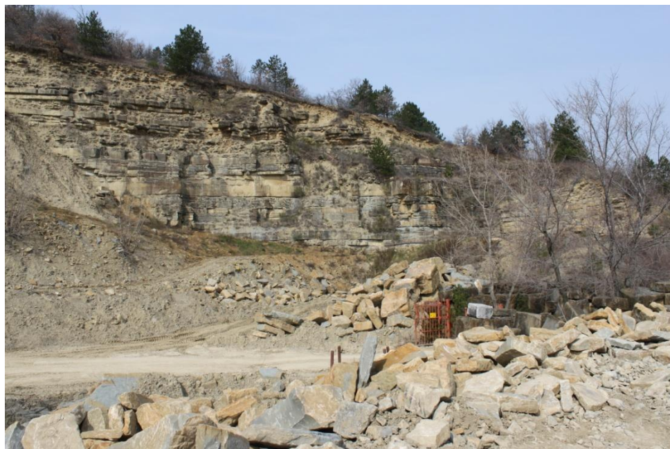
Figura 2-5 Coltivazione delle arenarie di Muggia, note come “masegno”, nella Cava Ex Gorlato (Ditta Renice S.r.l., TS)
