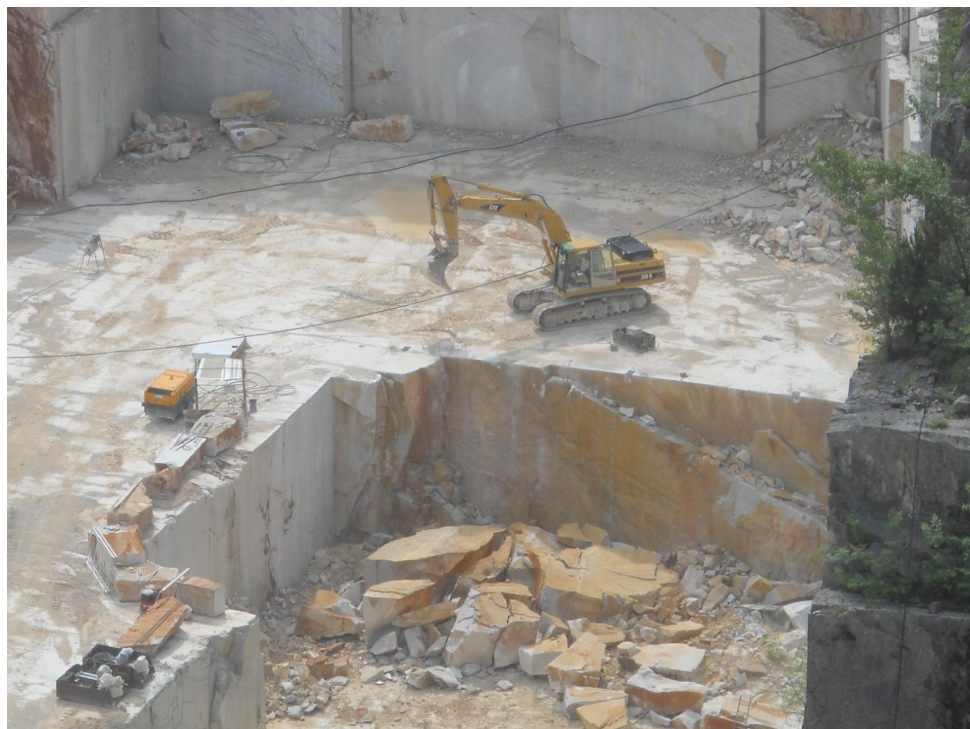
Figura 4-54 Effetto di un ribaltamento in materiale altamente fratturato (Cava Ivere – Romana, TS)
