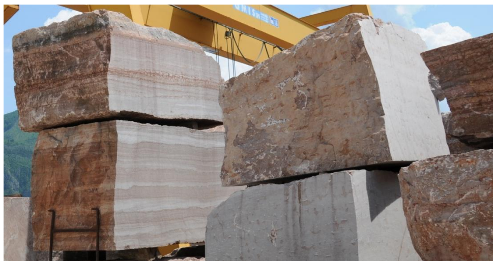
Figura 2-13 Blocchi di "Noce Radica" di Verzegnis in fase di riquadratura ed in deposito (Cava Monte Lovinzola, UD)
