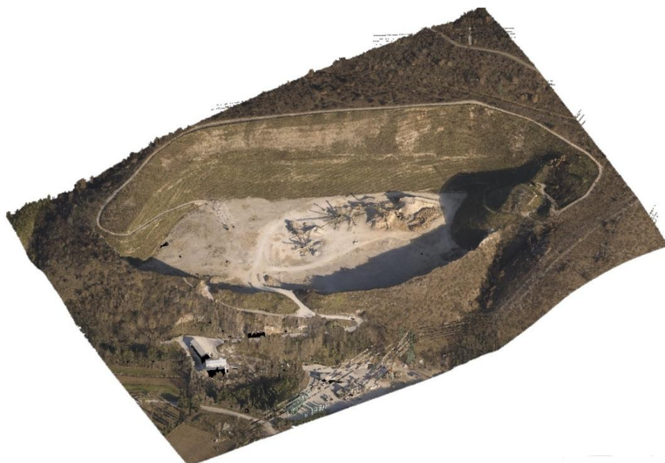
Figura 4-2 Vista 3D della cava di aggregati Monte Sei Busi (GO) ottenuta mediante rilievo laser scanner da elicottero
