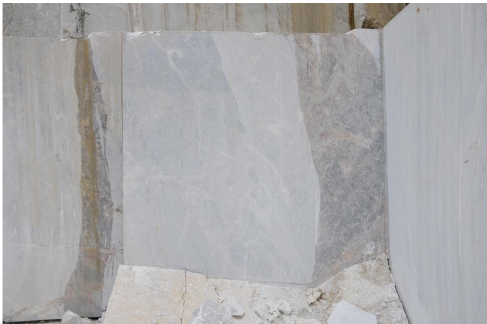
Figura 2-9 Coltivazione per gradino basso nella cava del marmo "Fior di Pesco" (Cava Avanza, UD)
