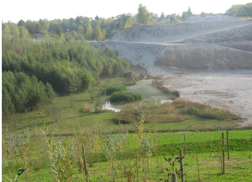
Figura 4-5 Coltivazione in fossa di una cava di pianura (Cava Impresa Avianese, PN)
