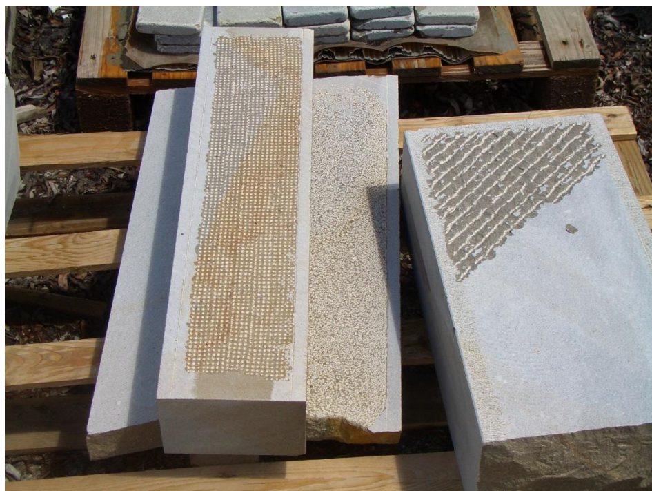
Figura 2-28 Trattamento della superficie mediante “fiammatura” manuale e “bocciardatura” della Pietra Piasentina
