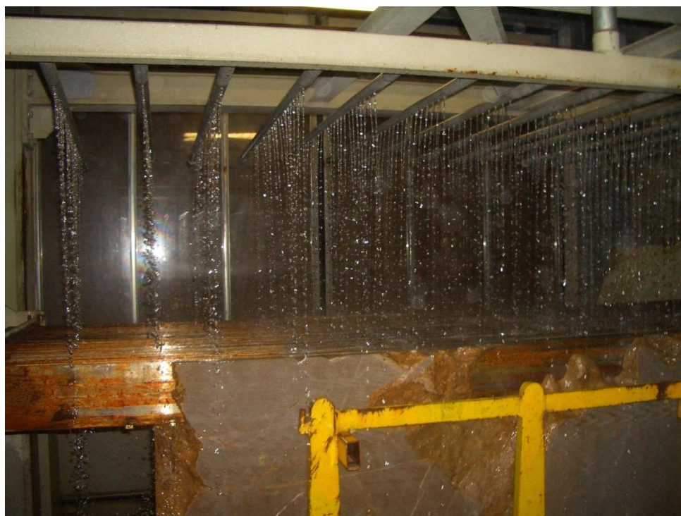
Figura 2-26 Riquadratura dei blocchi informi e successivo taglio al telaio della Pietra Piasentina (Ditta Julia Marmi di Laurino M. e C., UD)
