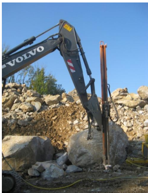
Figura 4-36 Coltivazione per squadratura di trovanti di Pietra Piasentina (Cava Altovizza, UD)
