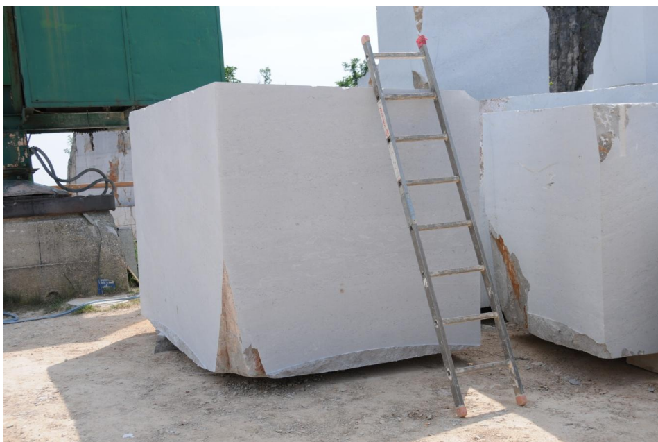
Figura 2-25 Blocco di Repen Classico Zolla: durante la riquadratura con taglio al filo statico ed a termine operazione (Cava Babce Nord, TS)
