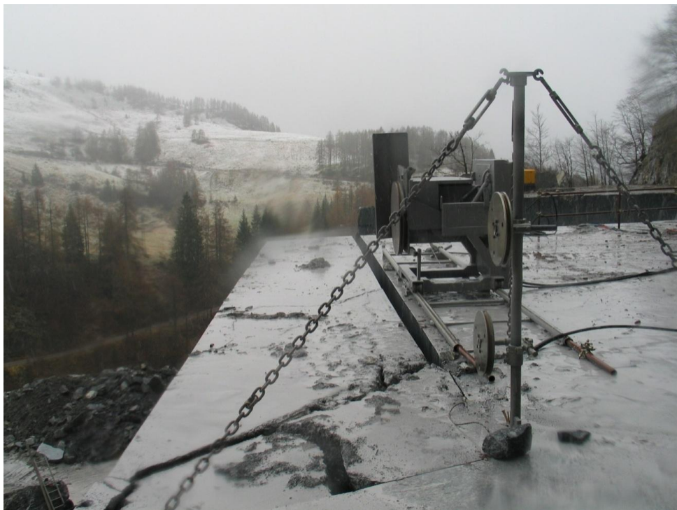
Figura 4-47 Taglio verticale con filo diamantato (Cava Pramosio, UD)
