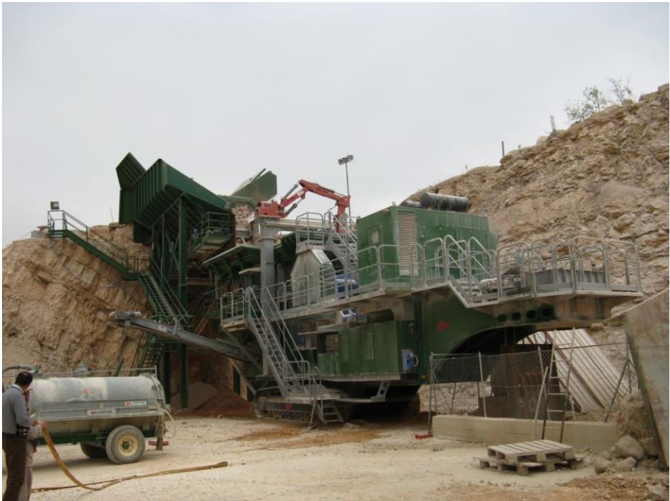
Figura 4-42 Frantumazione primaria sul piazzale di cava in corrispondenza del fornello di gettito (Cava La Mata, PN)
