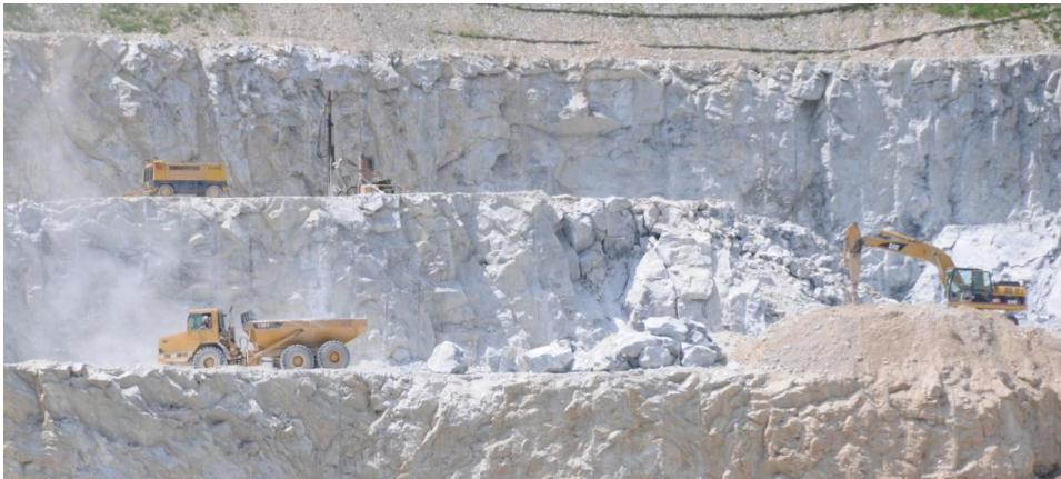
Figura 4-39 Coltivazione a gradoni subverticali con esplosivo (Cava Entrampo, UD)
