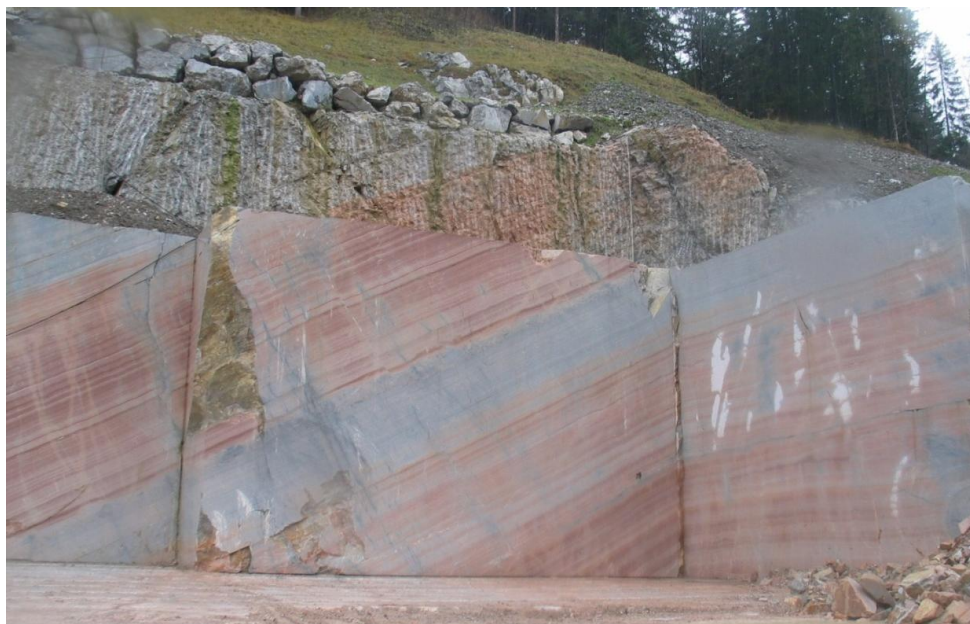
Figura 2-12 Coltivazione per bancate alte del "Rosso Onciato" (Cava Koul Troten, UD)
