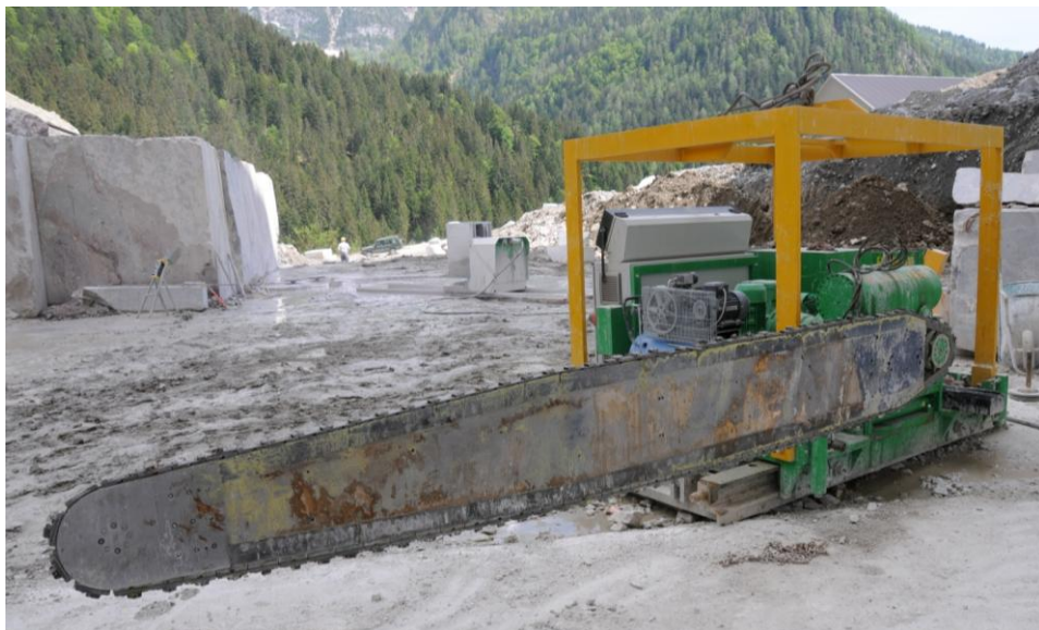
Figura 4-51 Tagliatrice a catena per il taglio al monte e alla base su gradino basso (Cava Avanza, UD)
