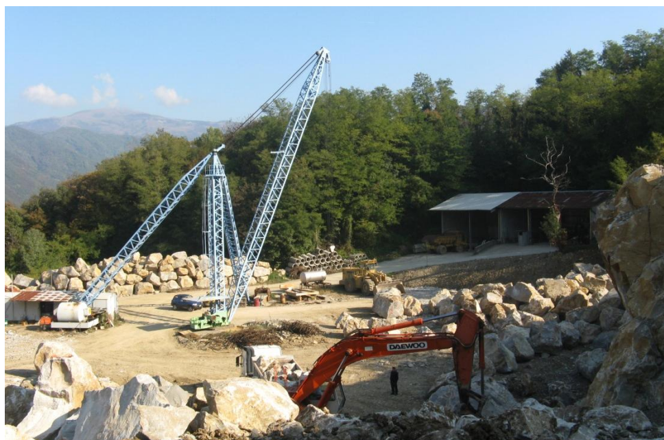
Figura 4-61 Movimentazione mediante gru derrick (Cava Altovizza, UD)
