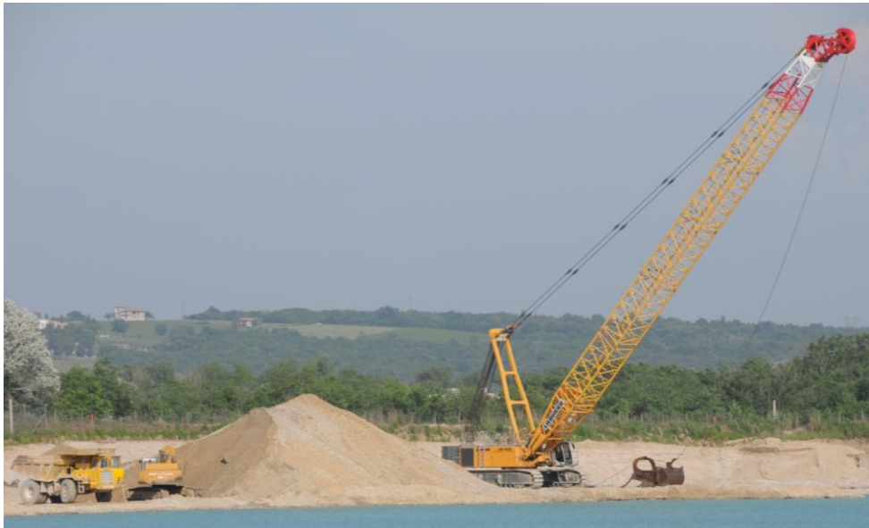
Figura 4-43 Cantiere di estrazione sotto falda: dragline con benna da 6 m 3 (produzione 150 m 3 /h), escavatore idraulico a benna diritta e dumper (Cava Foss Omblar, GO).
