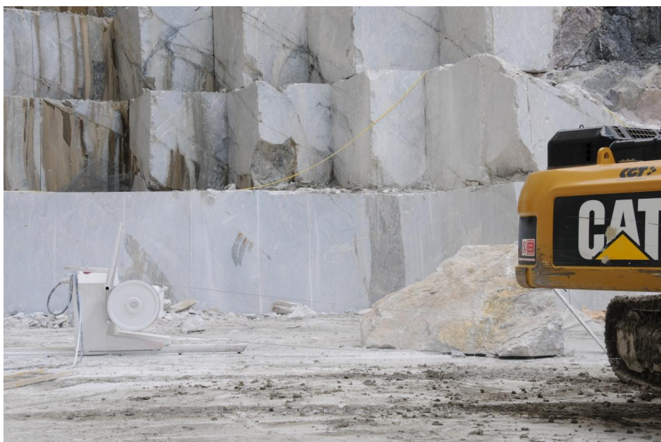
Figura 4-56 Riquadratura con filo diamantato (Cava Avanza, UD)
