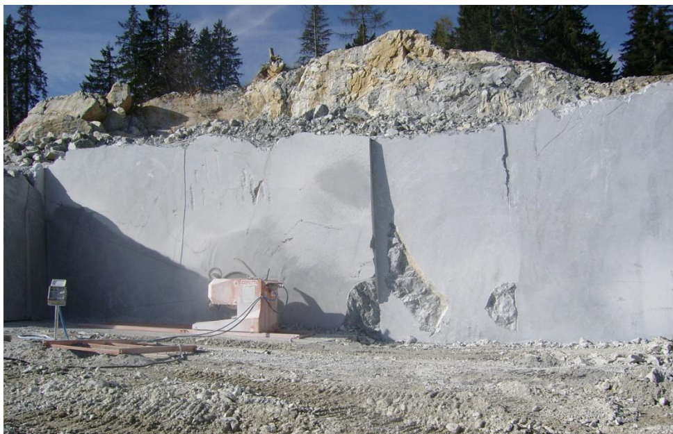
Figura 2-10 Coltivazione con filo diamantato nella cava del marmo "Grigio Naguscel Carnico" (Cava Clap di Naguscel, UD)
