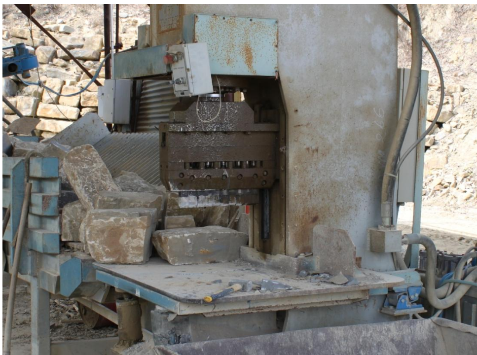
Figura 2-29 Lavorazione "a spacco" del masegno di Muggia (TS)
