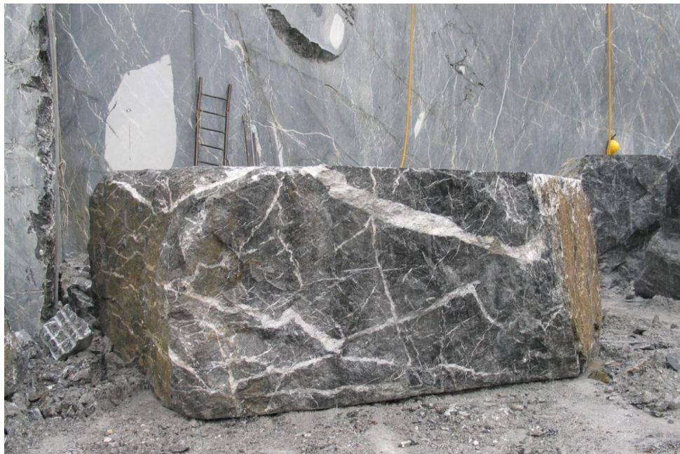
Figura 2-11 Coltivazione per bancate alte di marmo "Grigio Carnico": blocco risultante dopo il ribaltamento sul piazzale (Cava Pramosio, UD)
