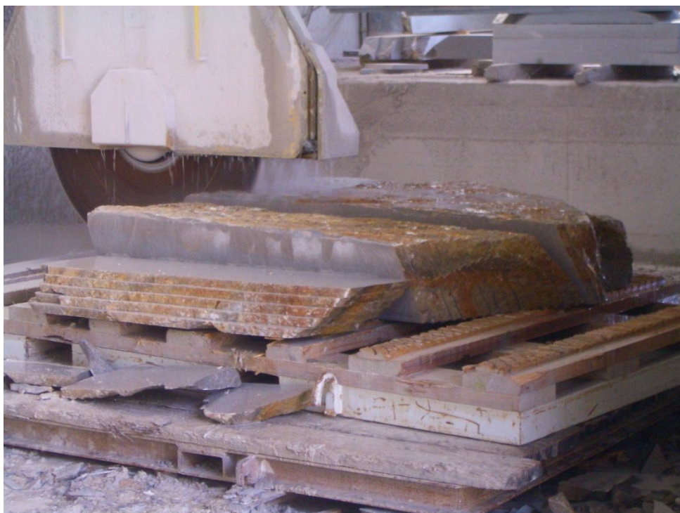
Figura 2-20 Produzione delle filagne da riquadrare di Pietra Piasentina presso il laboratorio della Ditta S.A.P.P.T. di Cecino e C. (UD)
