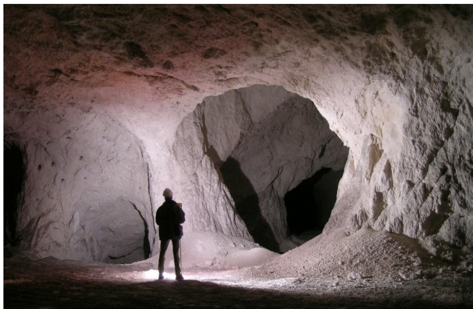
Figura 4-11 Gallerie utilizzate per la coltivazione selettiva del marmorino di Caneva (Cava Pedemonte – Valmadonna, PN)
