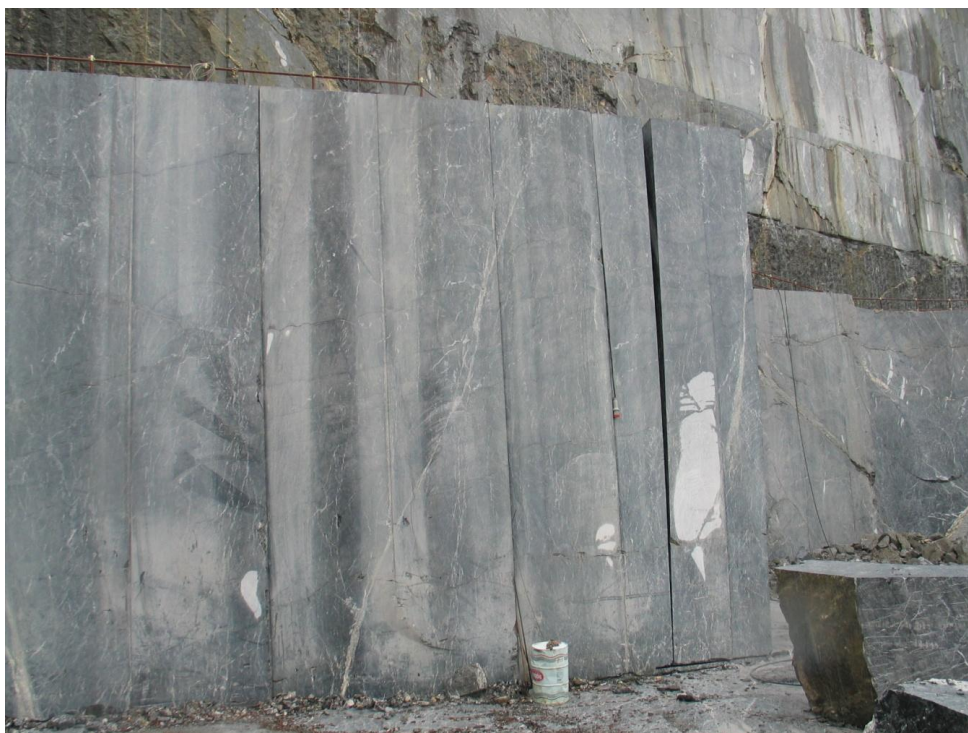
Figura 4-55 Fase di ribaltamento (Cava Pramasio, UD)
