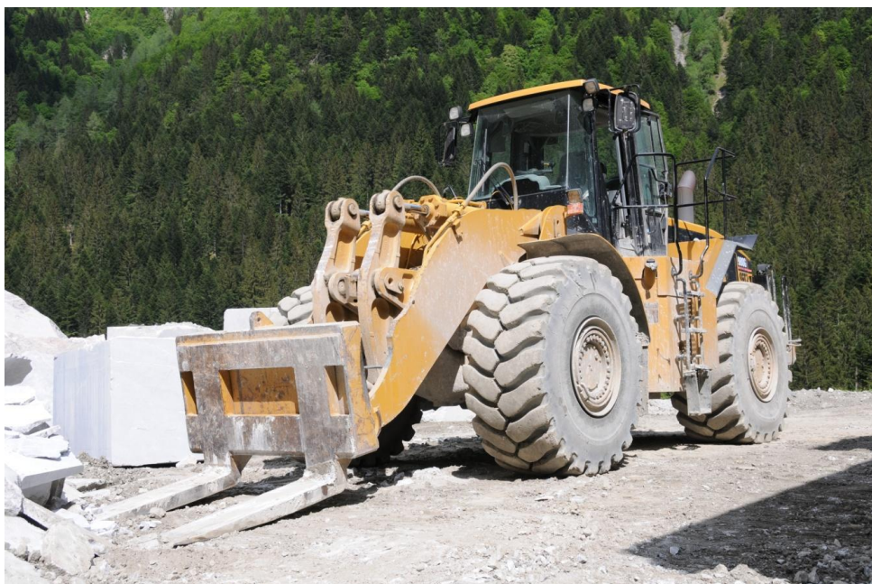
Figura 4-59 Pala gommata dotata di forche per il trasporto dei blocchi di cava (Cava Avanza, UD)
