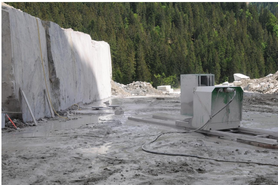
Figura 4-48 Taglio orizzontale con filo diamantato (Cava Avanza, UD)
