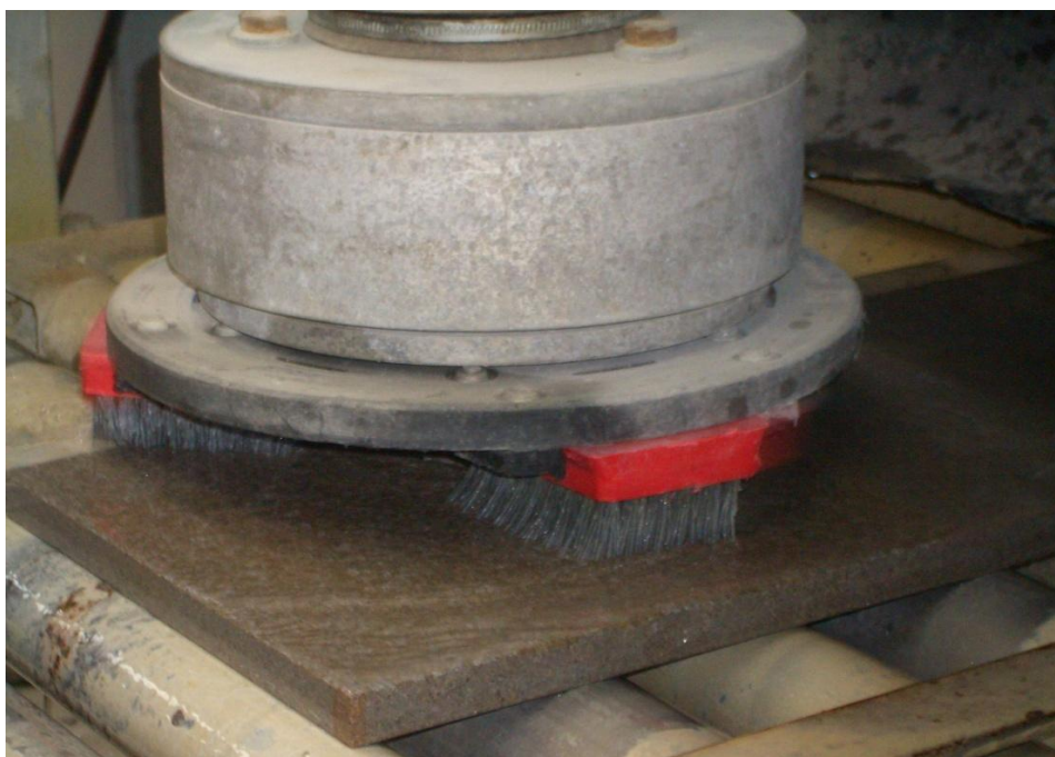
Figura 2-27 Trattamento della superficie mediante “fiammatura e spazzolatura” automatizzate della Pietra Piasentina (Ditta Julia Marmi di Laurino M. e C., UD)
