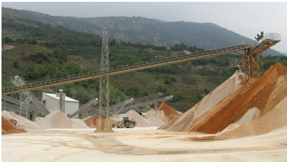
Figura 4-19 Impianto di produzione dell'aggregato della Cava La Mata (PN) posto allo sbocco della galleria di base nel piazzale della Ex Cava Livenzetta
