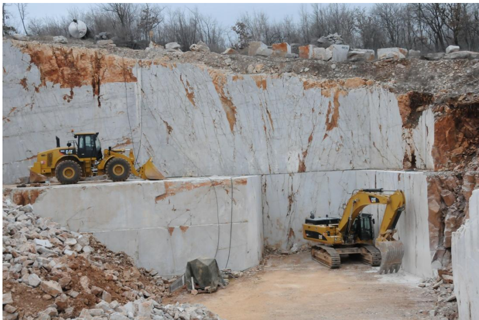
Figura 4-58 Pala gommata ed escavatore a benna rovescia per la movimentazione dei blocchi di cava (Cava Carlo Skabar, TS)
