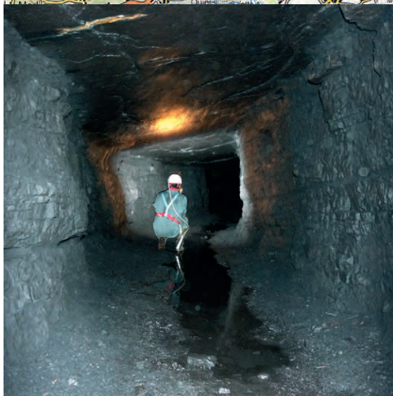
Cludinico: galleria con la classica sezione rettangolare e il concrezionamento, in calcite con ossidi e idrossidi, in una pozza.
